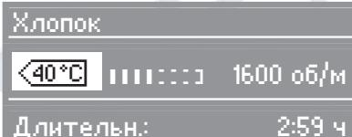
С помощью кнопки **V** температура может быть понижена и с помощью кнопки **A** повышена.
